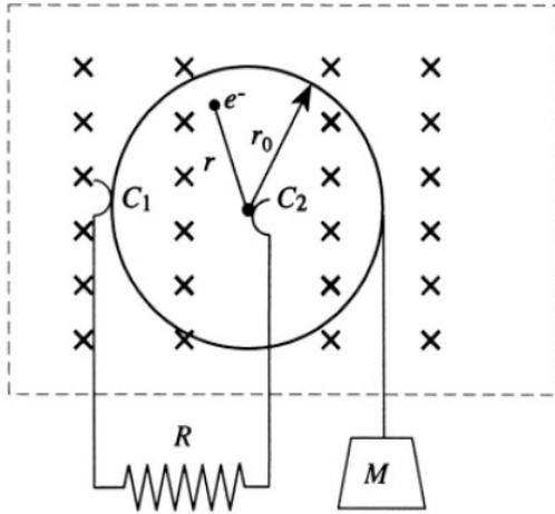
D'où l'existence d'une force radiale :  $\mathbf{F}_r = \frac{e}{c}[(\boldsymbol{\omega} \times \mathbf{r}) \times \mathbf{B}] = \frac{e}{c} \omega B r$  (0,5p.) On en déduit le champ électrique correspondant  $E = -(1/c)\omega B r$ , et la tension :
